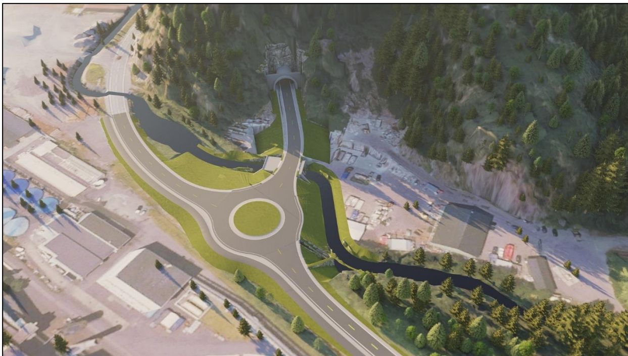
Figur 3-48. Omlegging av Kleivsbekken i de nedre deler før utløp i Fedafjorden.
