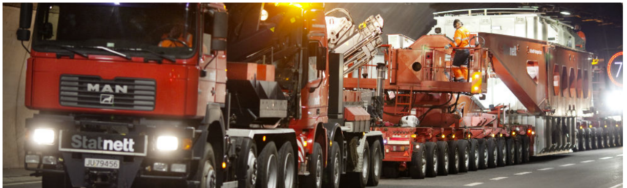
Bilde: Eksempel på spesialtransport av trafo.
