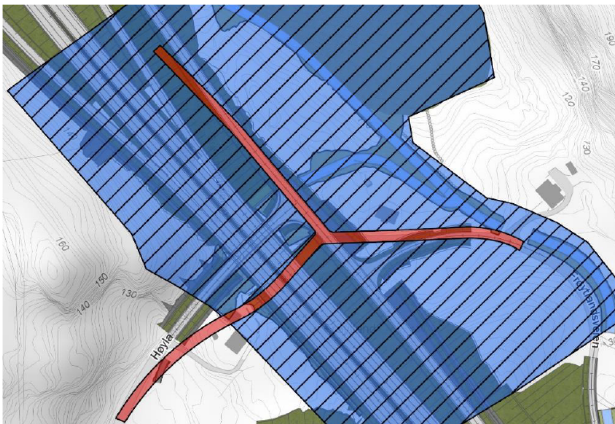
Fig. 10 Midlertidig omlegging av kryss ved bygging av kulvert.
