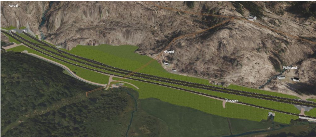
Figur 7-23: Fidjeland til Vatlandstunnelen. Utslaking av veifylling på Stegган, masselager/voll og omlagt bekk langs ny trasé for Dragedalen
