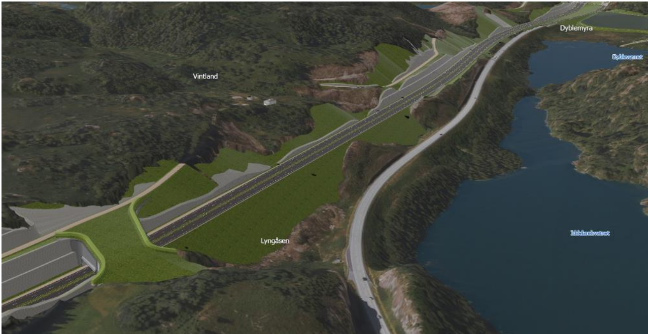
Figur 7-17: Viltkryssing ved Lyngåsen og ny E39 langs dagens E39 Iddelandsvatnet og Dyblevannet
