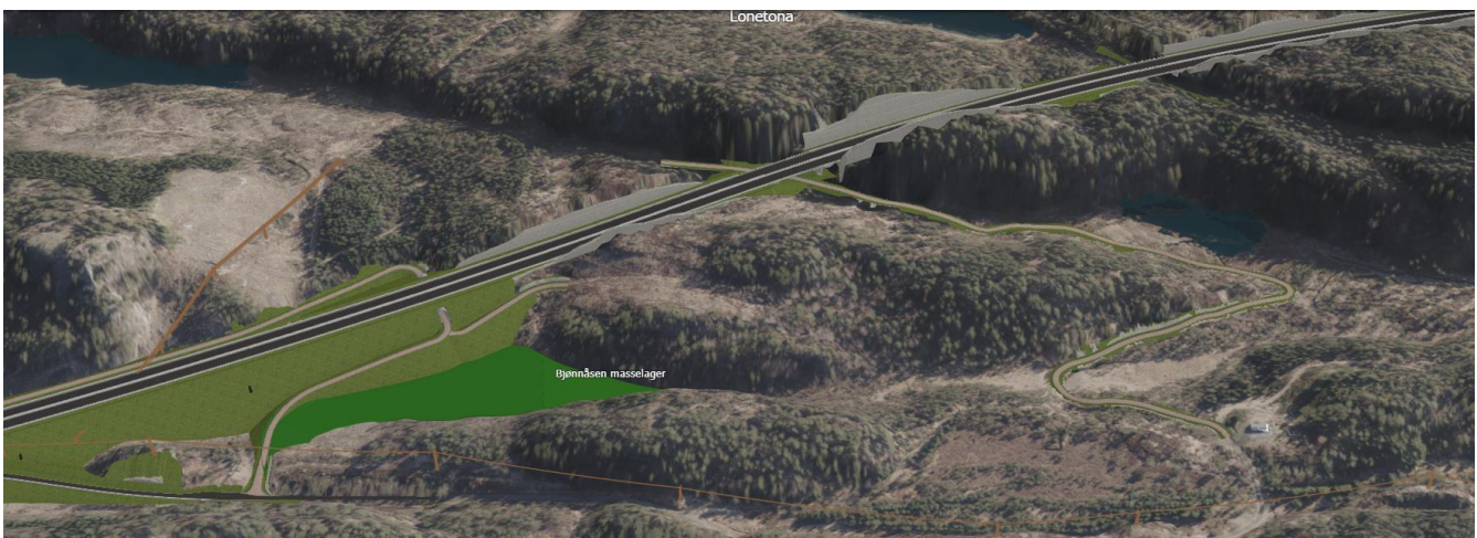
Figur 7-45: Anleggsveier inn mot veitraséen. Eksisterende skogsveier opprustes og forlenges.
