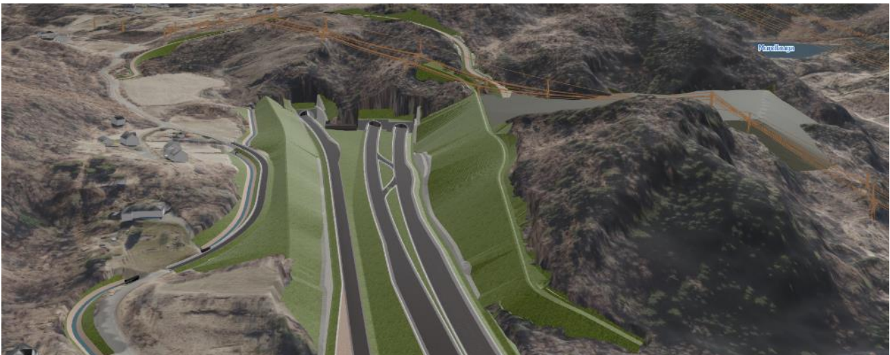
Figur 7-38: Portalområdet på Frøytland. Refstiheitunnelen, Øyetunnelen, omlagte bekker, masselager og den omlagte Frøytingsveien
