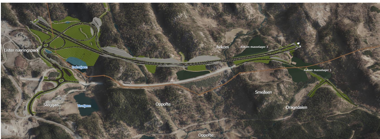
Figur 7-26: Vatlandstunnelen til Espedalstunnelen. Ny veikobling til Dragedalen ved Avkom, nytt kryss på Oppofte og ombygging dagens kryss
