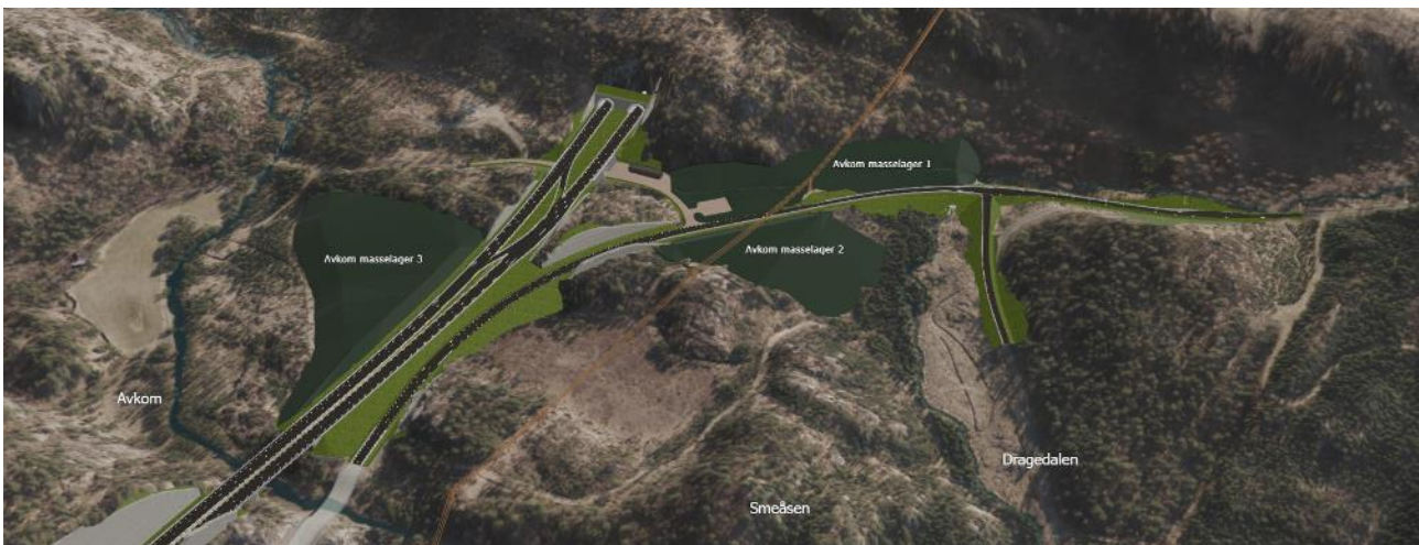
Figur 7-27: Avkom, med ny veikobling til Dragedalen, teknisk bygg, turparkering, tre masselager og ny bru over Strupåna
