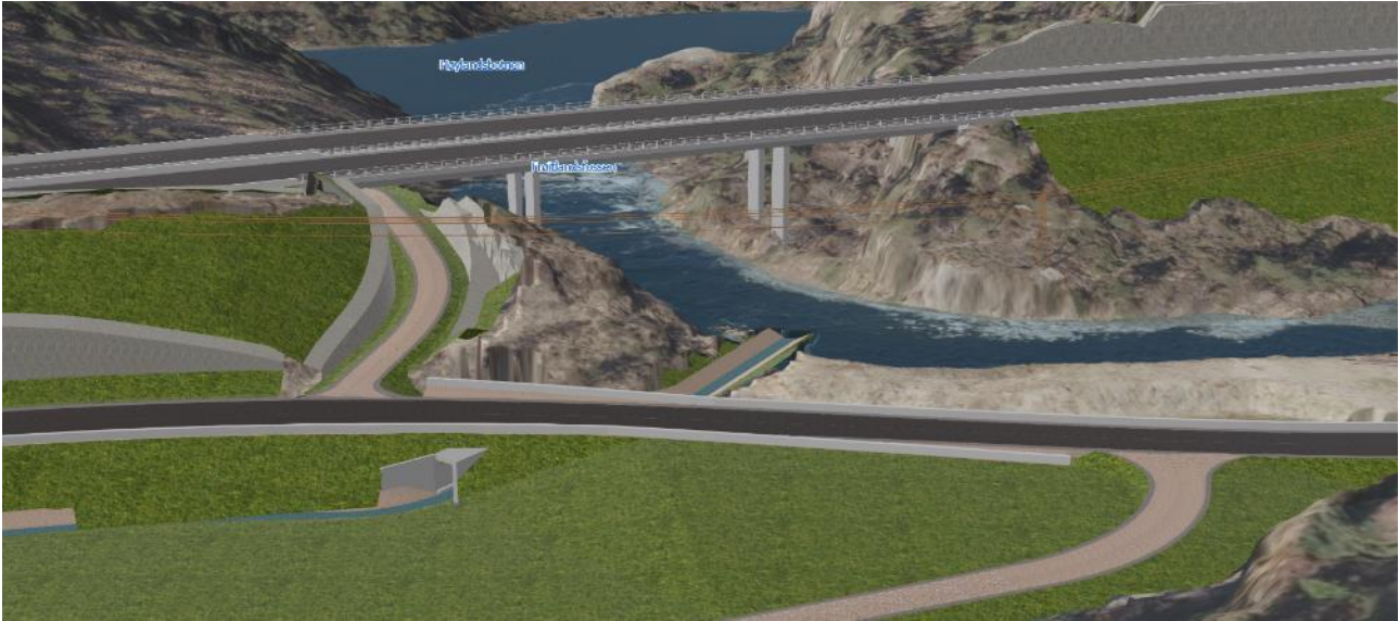
Figur 7-41: Ny E39 på seksfelts bru over Frøitlandsfossen. Passering for vilt under nordenden av brua og jordbruksadkomst under sørenden.
