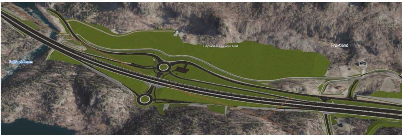
Figur 7-39: Nytt toplanskryss på Frøymland. Hevet og utvidet landbruksareal, omlagte bekker og Høylandsveien i kulvert under ny E39
