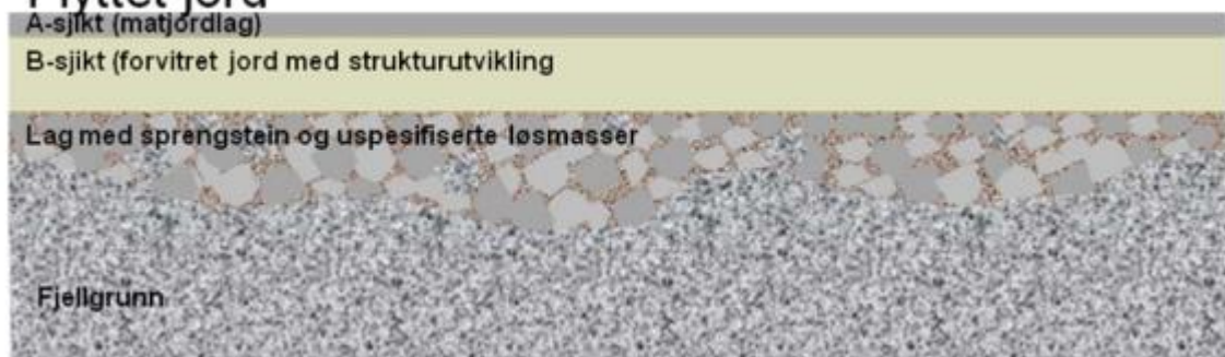
Figur 6-1 Oppbygning av jordprofil i naturlig lagret jord og flyttet jord (Bioforsk, 2012).
