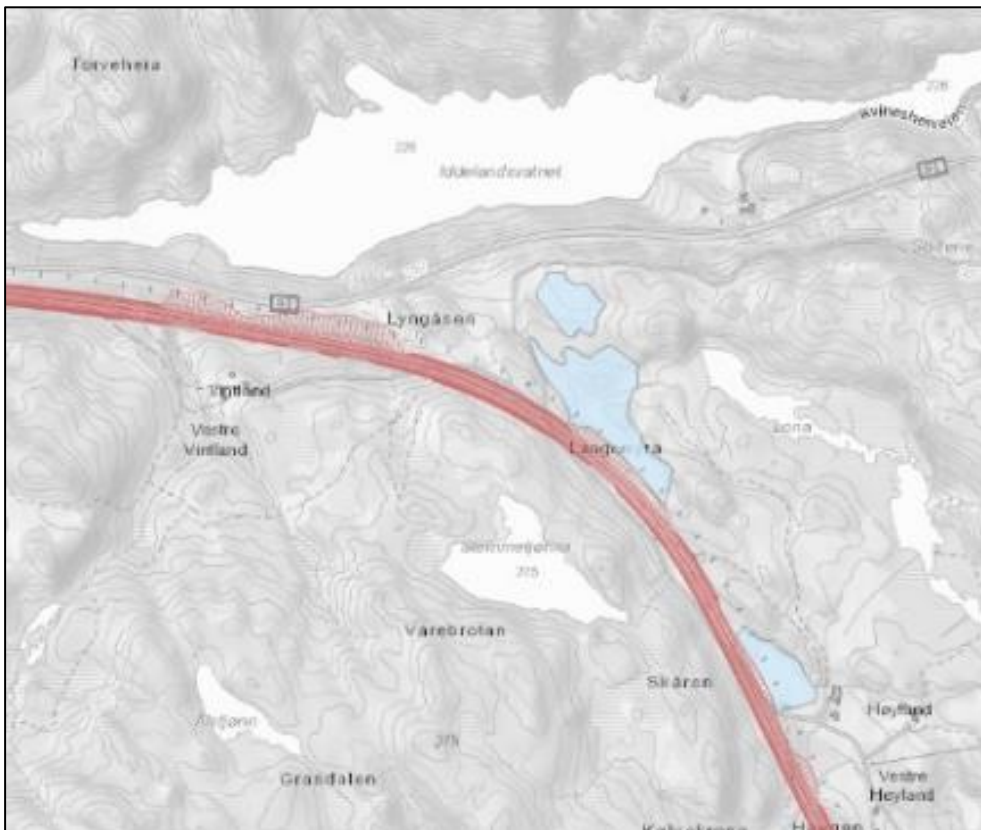
Figuren under er klippet fra medvirkningsportalen, og viser foreslått disponering av overskuddsmasser for linje 6, øverst i Høylandsdalen, ved Iddelandsvatnet (se blått areal).
