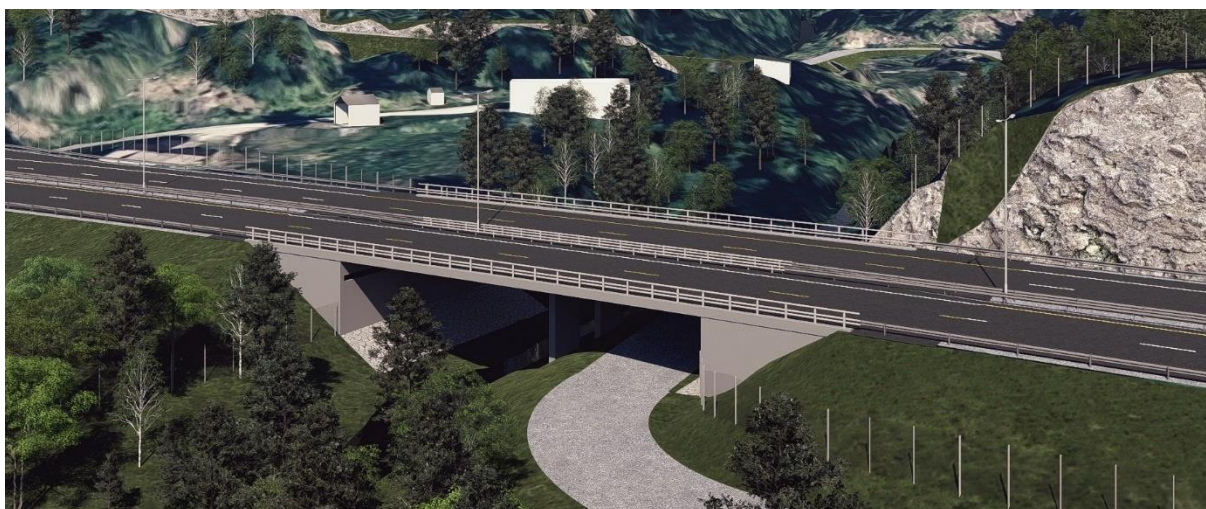
Figur 4-10 Auråa bru - illustrasjon med 3D-modell av brua. Sett mot nord. (Kilde: Sweco).
