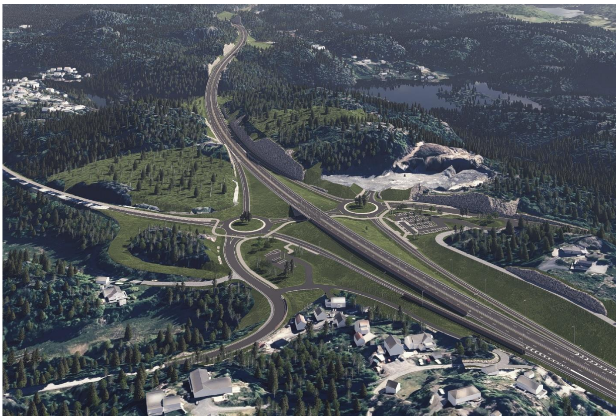
Figur 4-14 3D-modell av Gjerdemyra kryss. (Kilde: Sweco).
