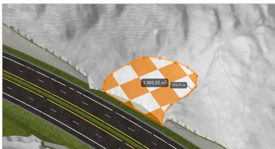
Figur 7-3: Myr 39 med skissert potensiale for nykonstruert myr med areal 1,0 daa og høyde 3,1 m. (Kilde: Sweco)
