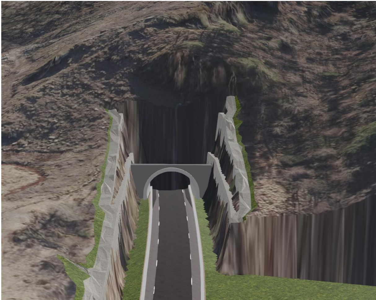
Figur 4-8: Påhugg vest, utklipp fra innsynsmodell. Påhuggsflate til Refstiheitunnelen er synlig til høyre.
