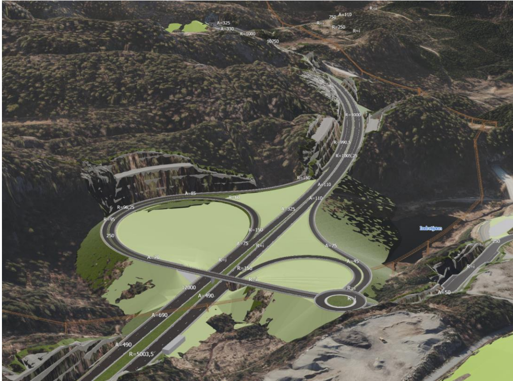
Figur 71: Utklipp fra 3D modellen, tatt retning S. Skjæringen i bildet blir 40-50 m høy.
