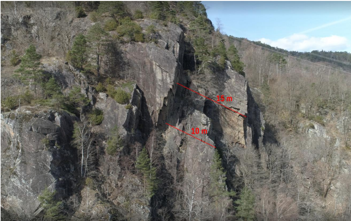
Figur 60: Bilde tatt mot N. Overside påhugg. Markert med omtrentlig størrelse på blokker, målt i kart.
