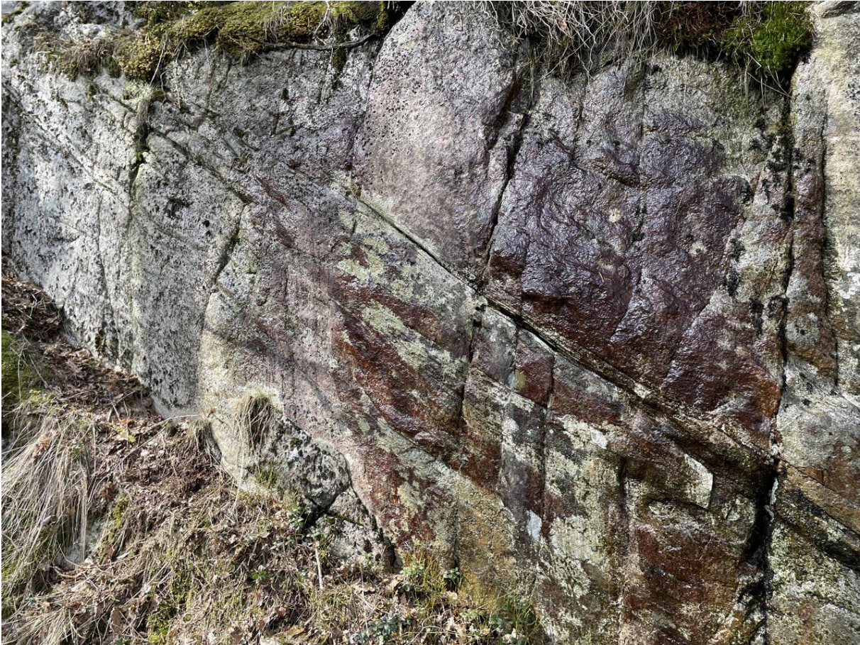
Figur 65: Foliasjonsplan, med sammenvokste sprekker og bølgete, ru plan.
