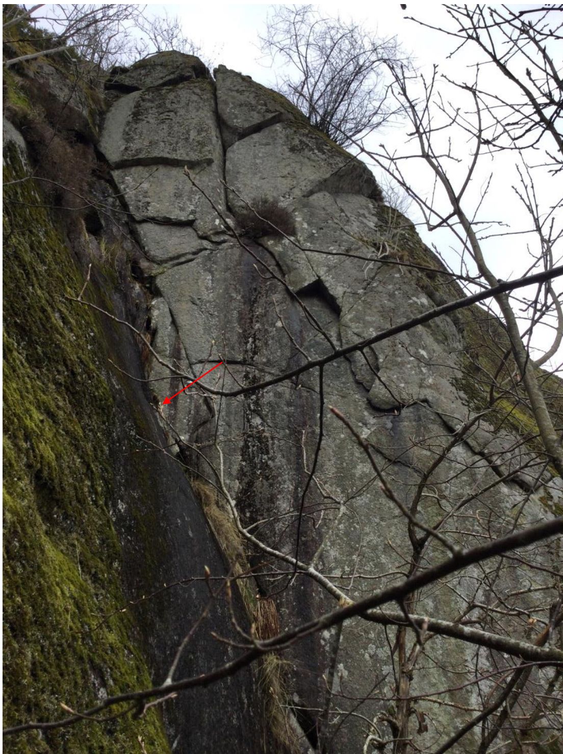
Figur 41 Bildet viser en gjennomsettende baksprekk som kutter inn i bergskrenten med slak vinkel til skrentens overflate, se rød pil. Bildet er tatt på vestsiden av bergskrenten.
