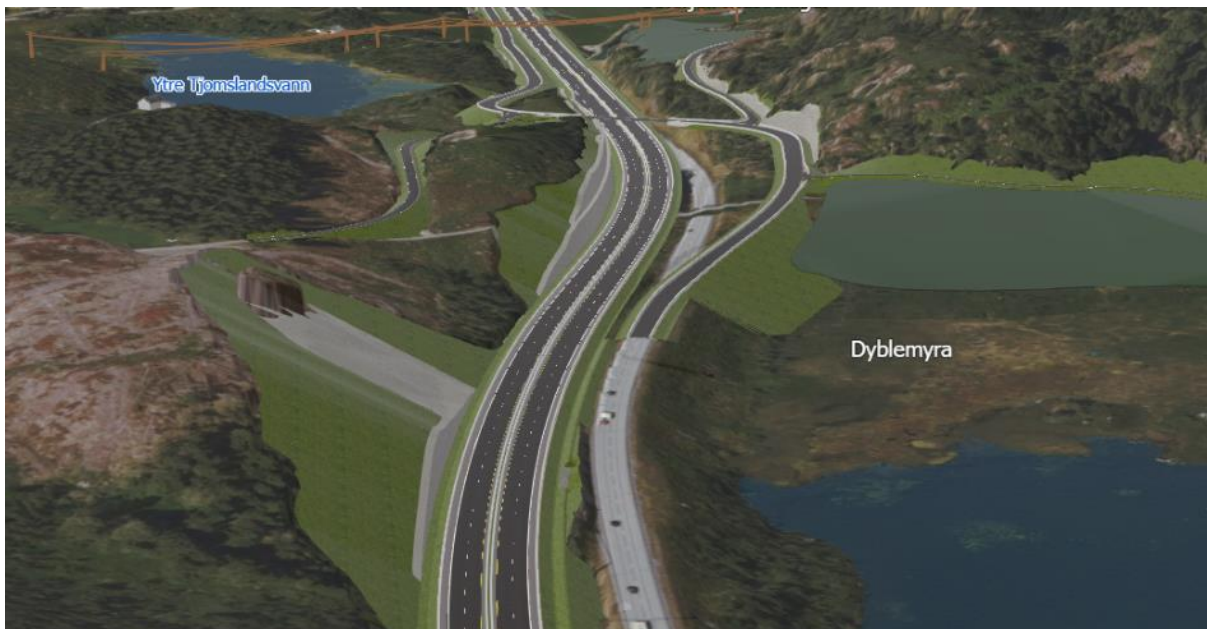
Figur 34: Utklipp fra innsynsmodellen som viser planlagte bergskjæring mellom profil 4615-5250. Utsnittet er tatt i retning vest (stigende profilnummer).
