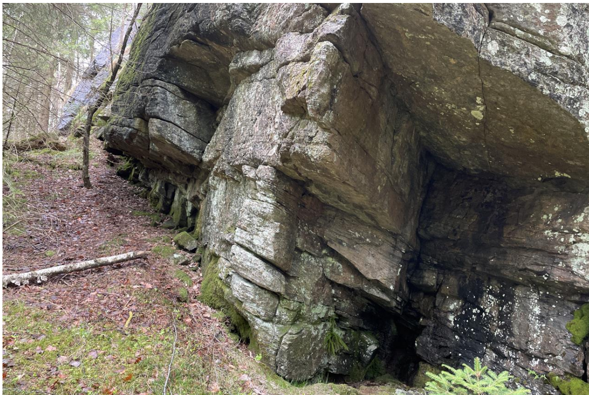
Figur 54: Tett oppsprukket bergmasse med bredde 0,5-2 meter i mellom avsatsene til sprekkesett 1 (foliasjonsplan) og sprekkesett 3. Observert ca. 500 meter vest for aktuelt område.
