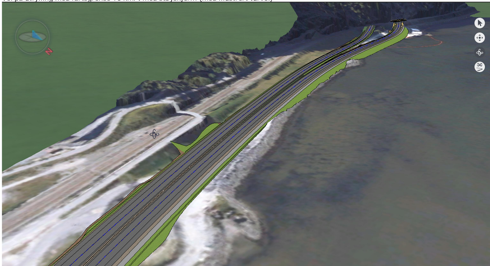
Vei på utfylling med fartsgrense 90 km/t med støyskjerm (med illustrert turvei)
