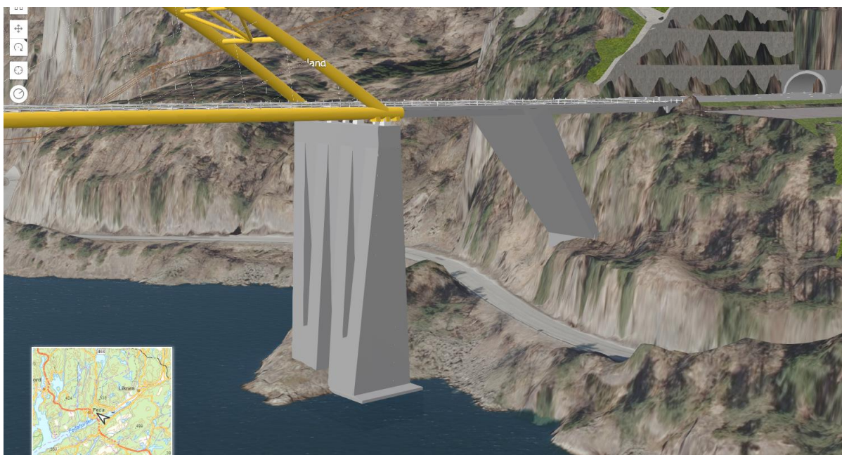
Figur 15: Utklipp fra modell som viser alternativ 1 nettverksbuebru med fundament på Skarpnes. Sett mot nordvest.
