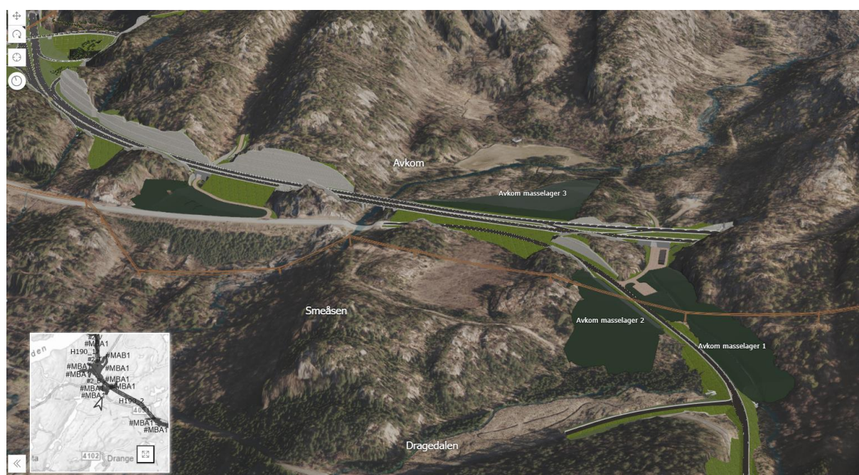
Figur 9: Utklipp fra 3D-innsynsløsning som viser veimodell og planlagte masselagre Avkom 1, 2 og 3. Synsvinkel mot nordøst.
